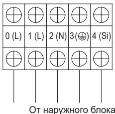
Клеммный терминал наружного блока
