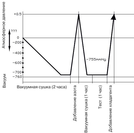
После первого вакуумирования добавьте в контур осушенный азот при давлении до  $25 \text{ кг}/\text{см}^2$  на 30 минут. Удалите азот и снова отвакуумируйте систему. После проверки на утечку добавьте хладагент.
