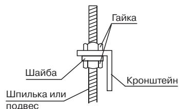
Навесьте внутренний блок на подвесные болты и закрепите. Выровняйте внутренний блок в горизонтальной плоскости при помощи уровня, иначе могут быть протечки конденсата.
